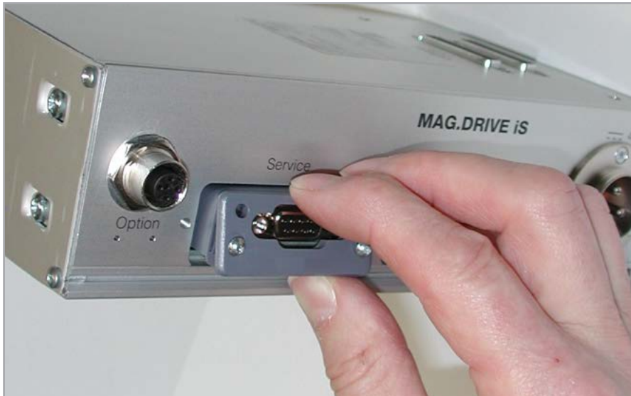
Abb.2.3 Modul einschieben
