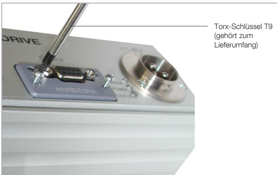
Abb.2.4 Modul festschrauben
