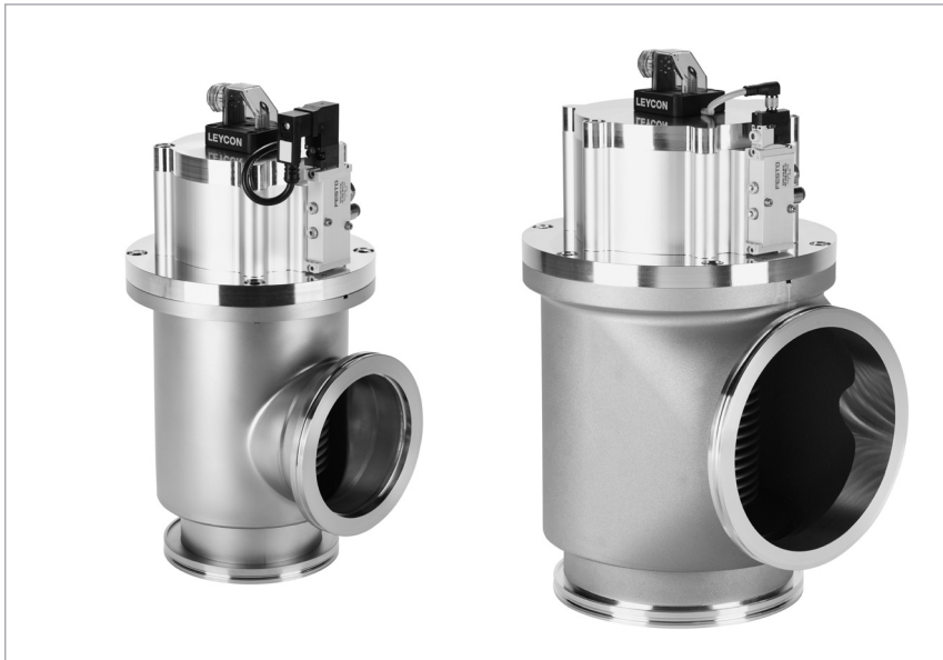
Eckventile mit Federbalg, elektropneumatischer Antrieb, Edelstahl, DN 100 ISO-K (links), Aluminium DN 160 ISO-K (rechts)
