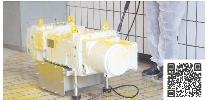
Vidéo de présentation de la pompe à vide à vis sèche et extrêmement robuste **DRYVAC** DV650 et test d'injection de 10 l d'eau à l'aspiration :
