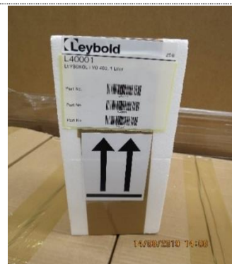
Exemple LVO 400 : Conditionnement d'une bouteille en verre dans du polystyrène et du ruban adhésif.
