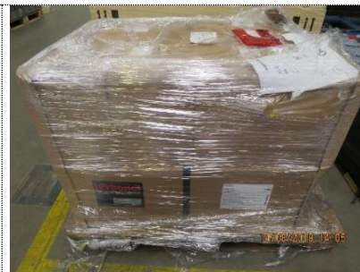
Exemple de conditionnement sur une palette Euro avec film étirable et protection de bordure.
